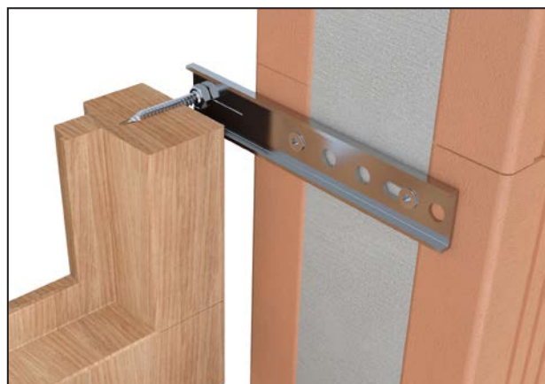
FMS-anker geplaatst op een houten raam
