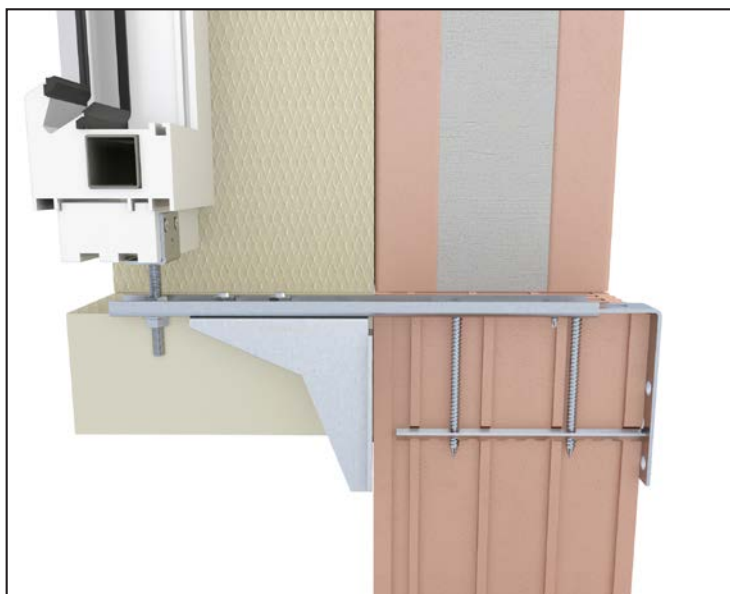
WU-ST-Anker met winkelhaak plaatje
